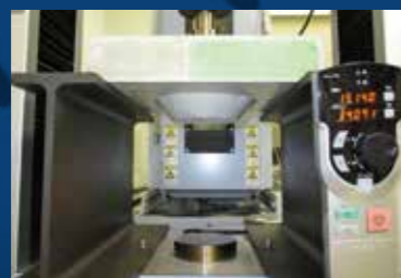
押し抜き試験
