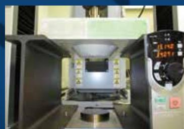
押し抜き試験
